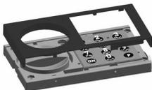
Blende wieder aufstecken und andrücken bis alle vier Rastpunkte eingerastet sind. Schloßfunktionen bei geöffnetem Behältnis überprüfen.
